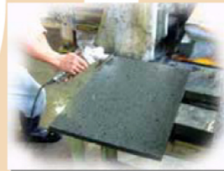
角を磨いて仕上げます 手加工で丁寧仕上げます
